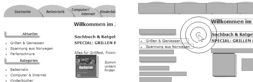
Abbildung 2: Ausschnitt einer Webseite (links) und Auswahl der auszugebenden Objekte durch die Fackelmetapher (rechts)
